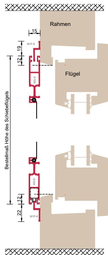
Variante MF-11MG mit Führungsschiene M1F oben und unten
